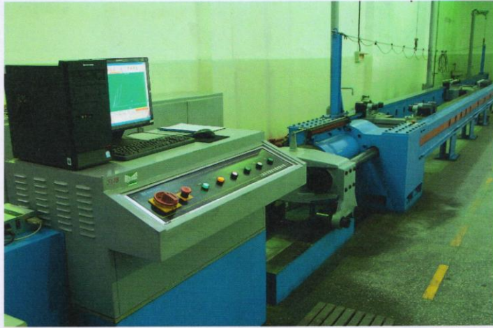
图 1-1 500kN 卧式拉力试验机
